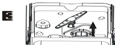
**Hinweis:** Bei Schritt 1 bis Schritt 3 wird das Filtersystem entfernt. Bitte gehen Sie zum Zusammensetzen in umgekehrter Reihenfolge vor.
