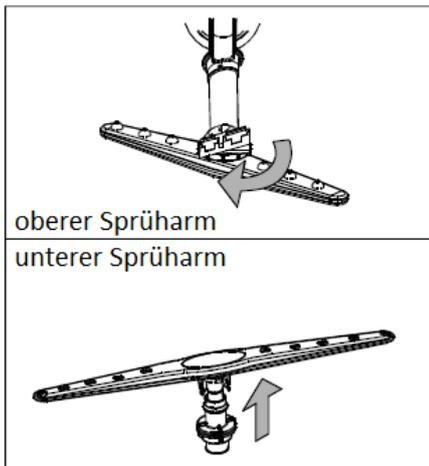
Die Sprüharme müssen regelmäßig von Kalkablagerungen gereinigt werden, sonst können die Düsen und Lager der Sprüharme verstopfen. Zum Entfernen des Sprüharms die Schraubenmutter nach rechts drehen, die Unterlegscheibe auf dem Arm herausnehmen und dann den Sprüharm selbst entfernen. Die Sprüharme in warmem Seifenwasser reinigen und mit einer weichen Bürste die Düsen säubern. Danach alles gut unter laufendem Wasser abspülen.
