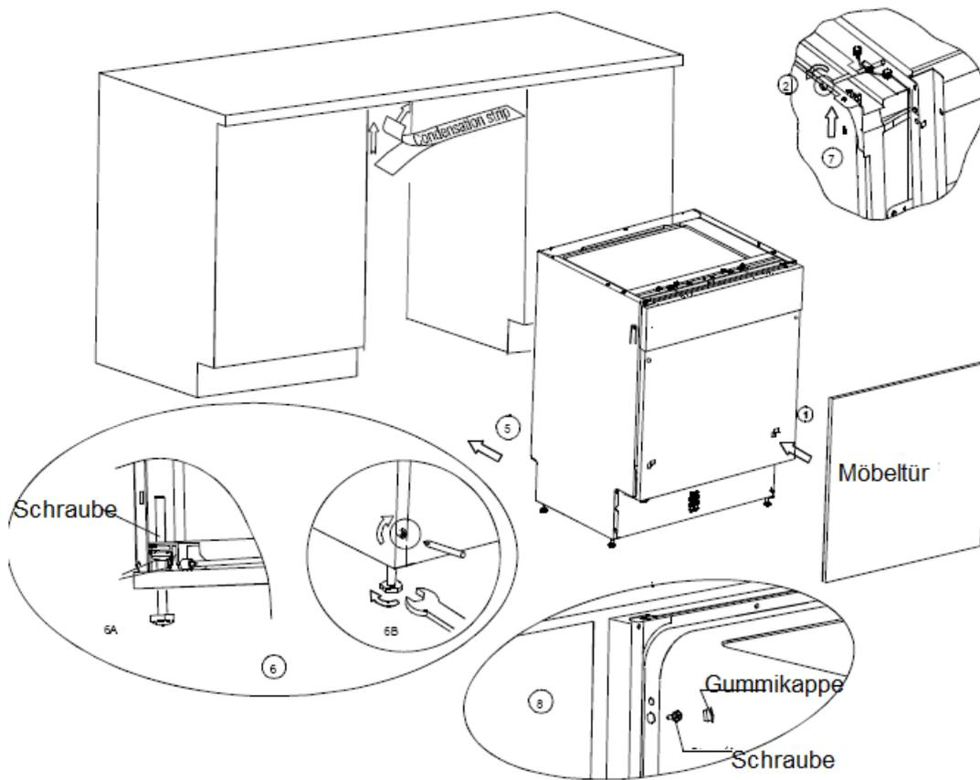
1. Befestigen Sie die Möbeltür mit den beigegeführten Klammern an der äußeren Spülmaschinentür. Siehe Vorlage bezüglich der Positionierung der Klammern.
