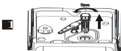
Schritt 2: Hauptfilter heraus heben
