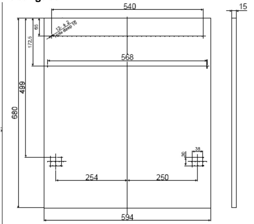
Die Haltewinkel an der Holz-Dekorblende anbringen und die Haltewinkel in die Führungsnute (Haken für die Holz-Dekorblende) an der Gerätevorderseite setzen, siehe Abb. 4a. Nach Positionierung der Holz-Dekorplatte diese mit den Schrauben und Stiften an der Aussentür des Gerätes fixieren. (Abb. 4 b)
