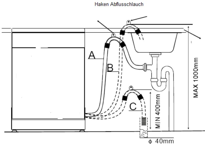
Den Schlauch in den Abfluss einführen, mindestens 4 cm Durchmesser oder in das Spülbecken halten. Hierzu kann man den Schlauchhalter (Haken Abflussschlauch) (Abb.7) benutzen. Dieser Schlauchhalter (Haken Abflussschlauch) muss fest an der Wand montiert werden um Bewegungen des Schlauches zu vermeiden.
