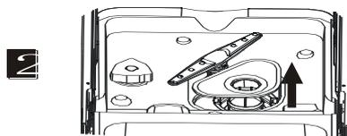
Schritt 3: Feinfilter heraus heben
